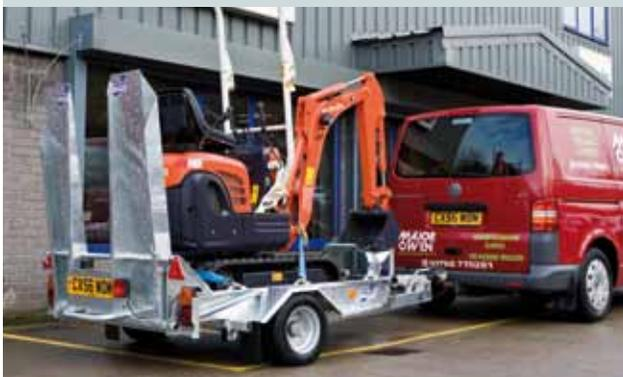
GH94 mit 195/55R10C Reifen und 120 cm Rampe mit Gitternetzfüllung
