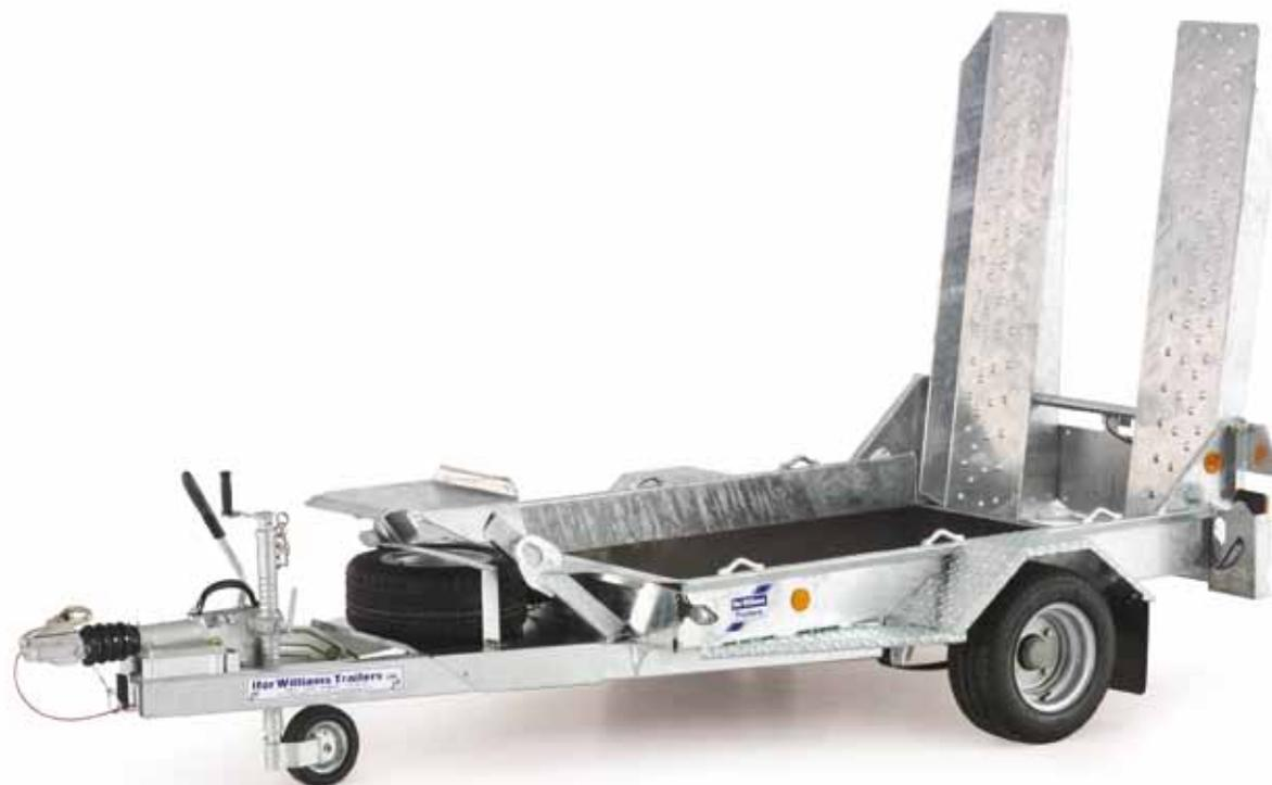
GH64 mit 150 cm Schienenrampe mit Seitenführung
